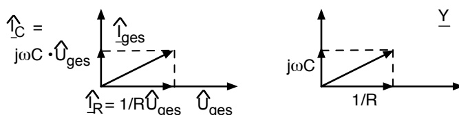
Abb. 4.38: Zeiger von Strömen und Admittanzen bei der Parallelschaltung von R und C
